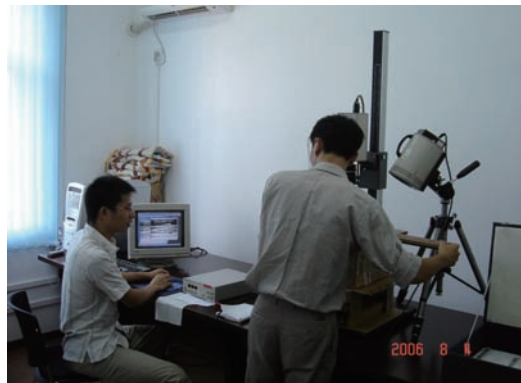
圖一：課題組的工作成員以紅外線成像系統（IRRS-100）對竹簡進行拍攝
